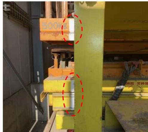
作業台部にラインによる目印を設置した状況
