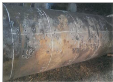
ポリエチレンスリーブ非装着管の腐食状況 【腐食性土壌 31 年経過】
