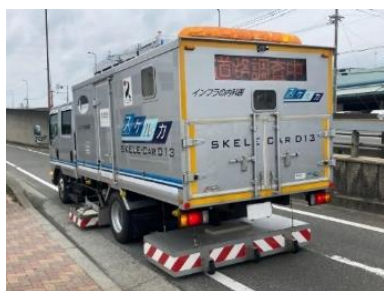
空洞調査を行う探査車
