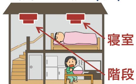
※天井又は壁の上部に、煙を感知するものを設置します。
