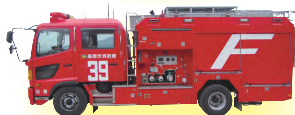
②ポンプ車(25台) 消火栓のほか川や池などから水を取り、消火したり、タンク車に水を送ったりします。(この車には0.6トン~1.5トンの水をつんでいます。)
