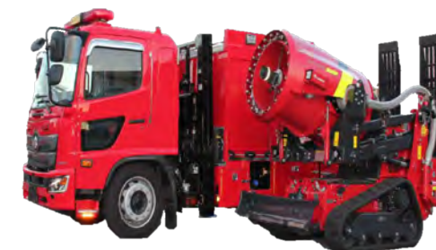
●特別高度工作車(1台) トンネルなどの火災のとき、煙や有毒ガスを風で外に出します。
