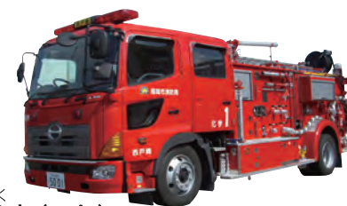
●化学車(2台) 水では消えない油火災のとき、あわを使って消火します。
