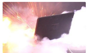
非純正品バッテリー搭載製品の発火事故の再現
