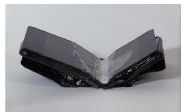
外部からの力により発火・燃焼したスマートフォン
