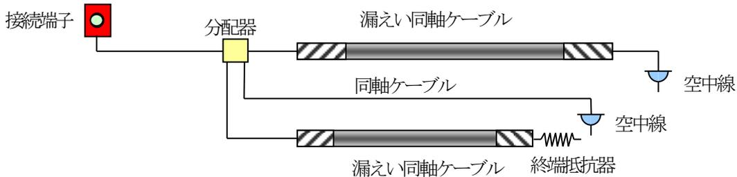
(2) 無線通信補助設備は、電波を輻射する漏えい同軸ケーブル及び空中線を防火対象物の屋内の部分に設けることとするほか、次によること。
