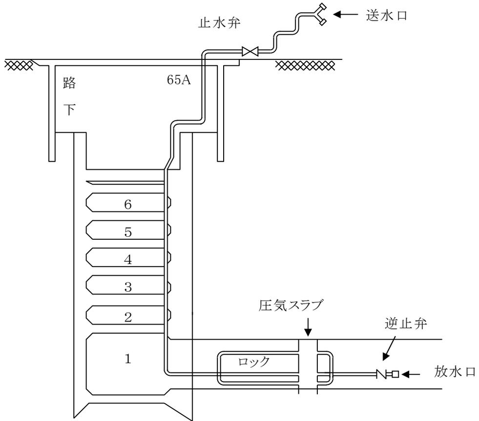
第6-2図 連結送水管の設置例（シールド圧気の場合）
