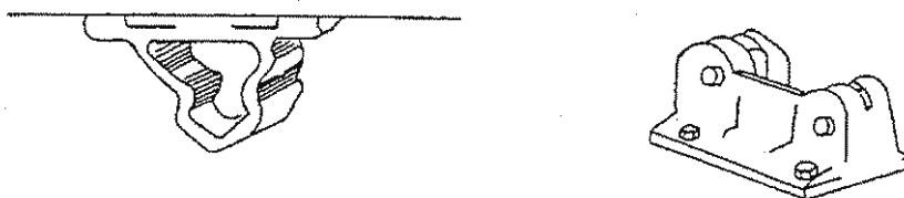
第10-60図 計算による強度計算を行う必要のない 緊締金具及びすみ金具
