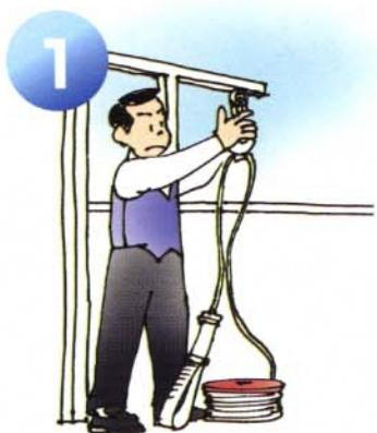
取付金具に調速器がしっかりと取り付けられているか確認します。
