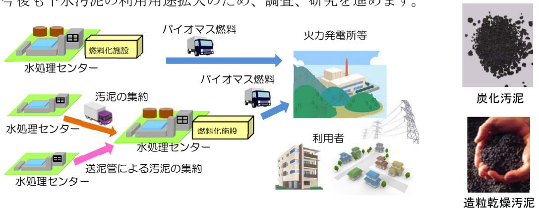
図 4. IV. 1 下水汚泥燃料化事業のイメージ（写真：日本下水道事業団資料より）
