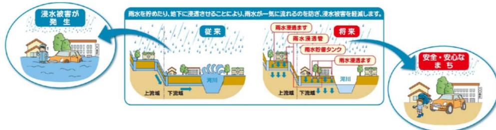
図 4. II. 3 雨水流出抑制施設の導入イメージ
