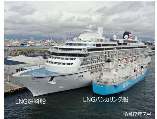
LNGバンカリング船による船舶へのLNG燃料の供給が可能。
