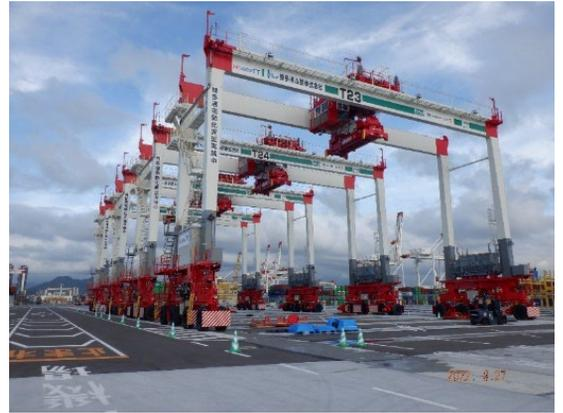
ターミナル内のコンテナ置き場でコンテナを積み降ろしする荷役機械。電動化により、従来のディーゼルエンジン型に比べ省エネ化を実現。
