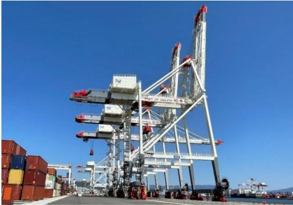
着岸した船のコンテナを積み降ろしする荷役機械。インバータ制御による荷役時の出力の最適化により、無駄な電力消費を抑制。
