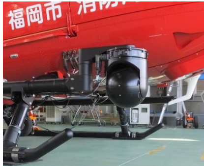
■ヘリテレカメラ 上空からの災害映像を指令センターに送信します。
