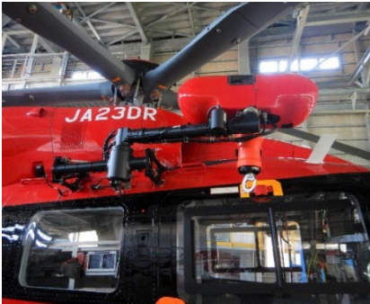
■ホイスト装置 隊員の吊り下ろしや要救助者の吊り上げに使用します。
