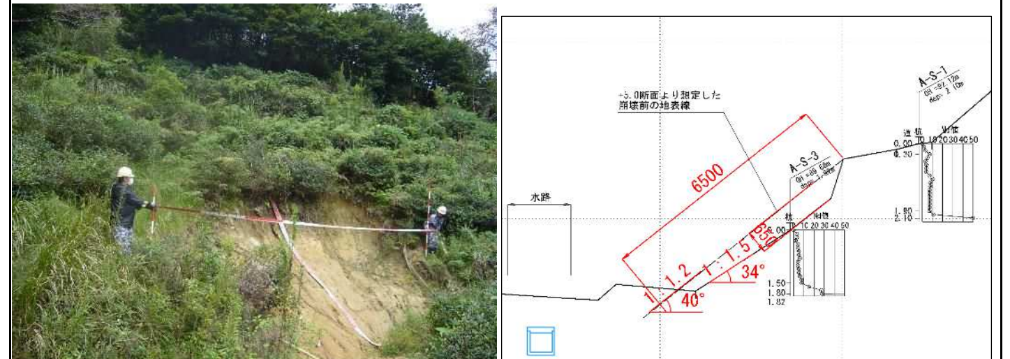
崩壊範囲 長さ：約6.5 m 幅：約8.5 m 斜面勾配 崩壊前(想定) 1:1.2 崩壊後1:1.5
