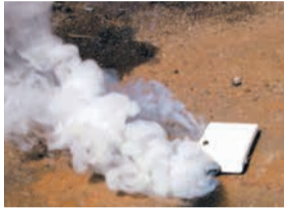
白煙が噴出するリチウムイオン電池
