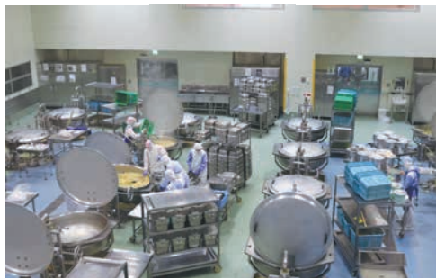
煮炊き調理室。直径120cm、一度に1,000人分の調理が可能な大きな回転釜24台で、汁物や煮物などを調理します
