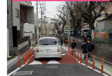
車両の速度を抑制するため、路面をなめらかに盛り上げるハンブ、車道の通行部分を狭くする狭さくを組み合わせた事例
