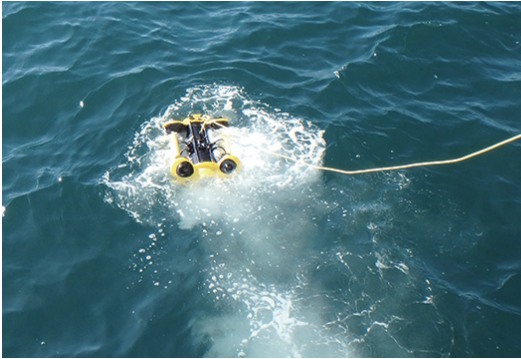
水中ドローンによる調査
