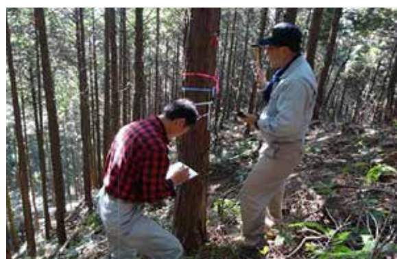
写真 2.3.1 伐採予定林での立木の強度測定
