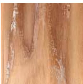
不良品 木口を塗り忘れて 塗膜が剥離した
