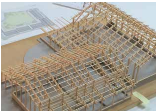
軸組模型を製作して必要部材を確認する
