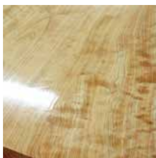
写真 4.2.6.1 造膜系塗料の仕上
