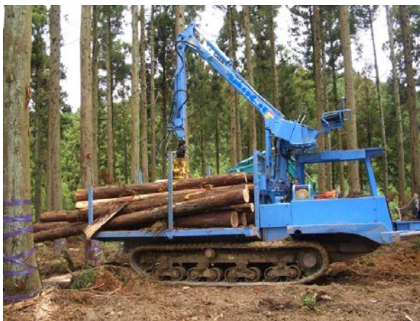
プロセッサ (左上) : 林道や土場などで、全木集材されてきた材の枝払い、測尺、玉切りを連続して行う自走式機械 ハーベスタ (右上) : 立木の伐倒、枝払い、玉切りの各作業と玉切りした材の集積作業を一貫して行う自走式機械 フォワーダ (左下) : 玉切りした短幹材をグラップルクレーンで荷台に積んで運ぶ集材専用の自走式機械
