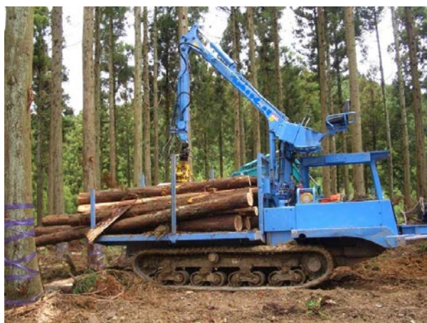
プロセッサ (左上) : 林道や土場などで、全木集材されてきた材の枝払い、測尺、玉切りを連続して行う自走式機械 ハーベスタ (右上) : 立木の伐倒、枝払い、玉切りの各作業と玉切りした材の集積作業を一貫して行う自走式機械 フォワーダ (左下) : 玉切りした短幹材をグラップルクレーンで荷台に積んで運ぶ集材専用の自走式機械
