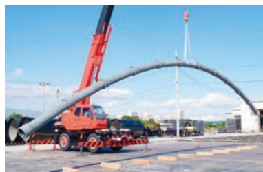
ダクタイル鋳鉄管(耐震管)の吊上げ実験の様子 写真提供：一般社団法人日本ダクタイル鉄管協会
