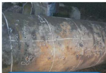
ポリエチレンスリーブ非装着管の腐食状況(31年経過後)
