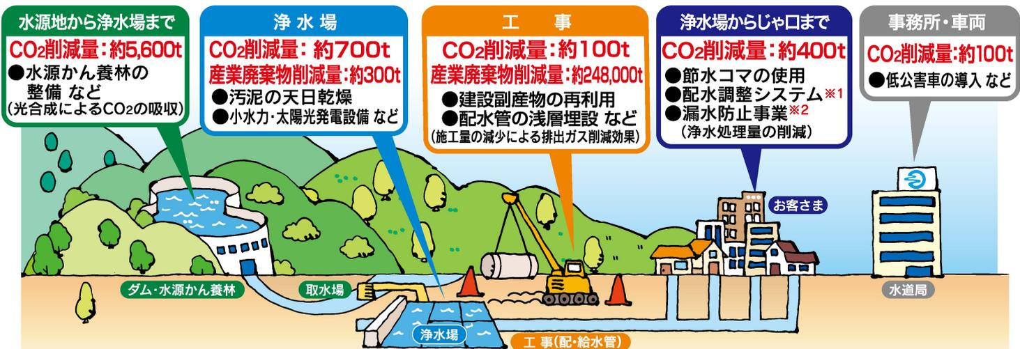
※1 配水調整システム：配水管に取り付けた流量計及び水圧計の情報をもとに電動弁を遠隔操作して給水区域にバランスよく給水し、漏水を抑制するシステム。
