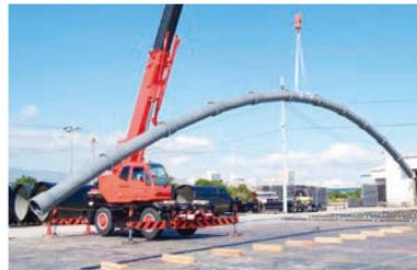
ダクタイル鋳鉄管(耐震管)の吊上げ実験の様子
