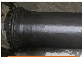
ポリエチレンスリーブ装着管の腐食状況(36年経過後)
