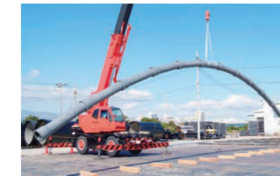
ダクタイル鋳鉄管(耐震管)の吊上げ実験の様子 写真提供：一般社団法人日本ダクタイル鉄管協会
