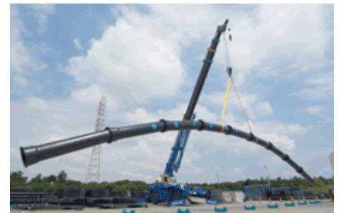
地震時の外力（圧縮・引張）に耐え、地盤の変形にも柔軟に追従する耐震管
