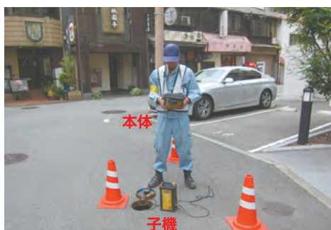
相関式漏水探知器を使用した漏水調査
