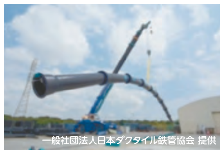
耐震管の吊り上げ実験の様子
