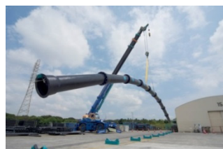
耐震管の吊り上げ実験の様子
