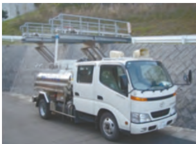
羽根戸配水場の注水設備と給水車
