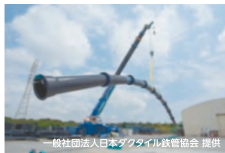
耐震管の吊り上げ実験の様子
