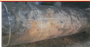
ポリエチレンスリーブ非装着管の腐食状況 【腐食性土壌31年経過】
