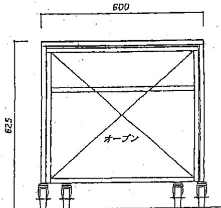
φ75 自在車 (樹脂製) ストッパー付 (溶接固定)
