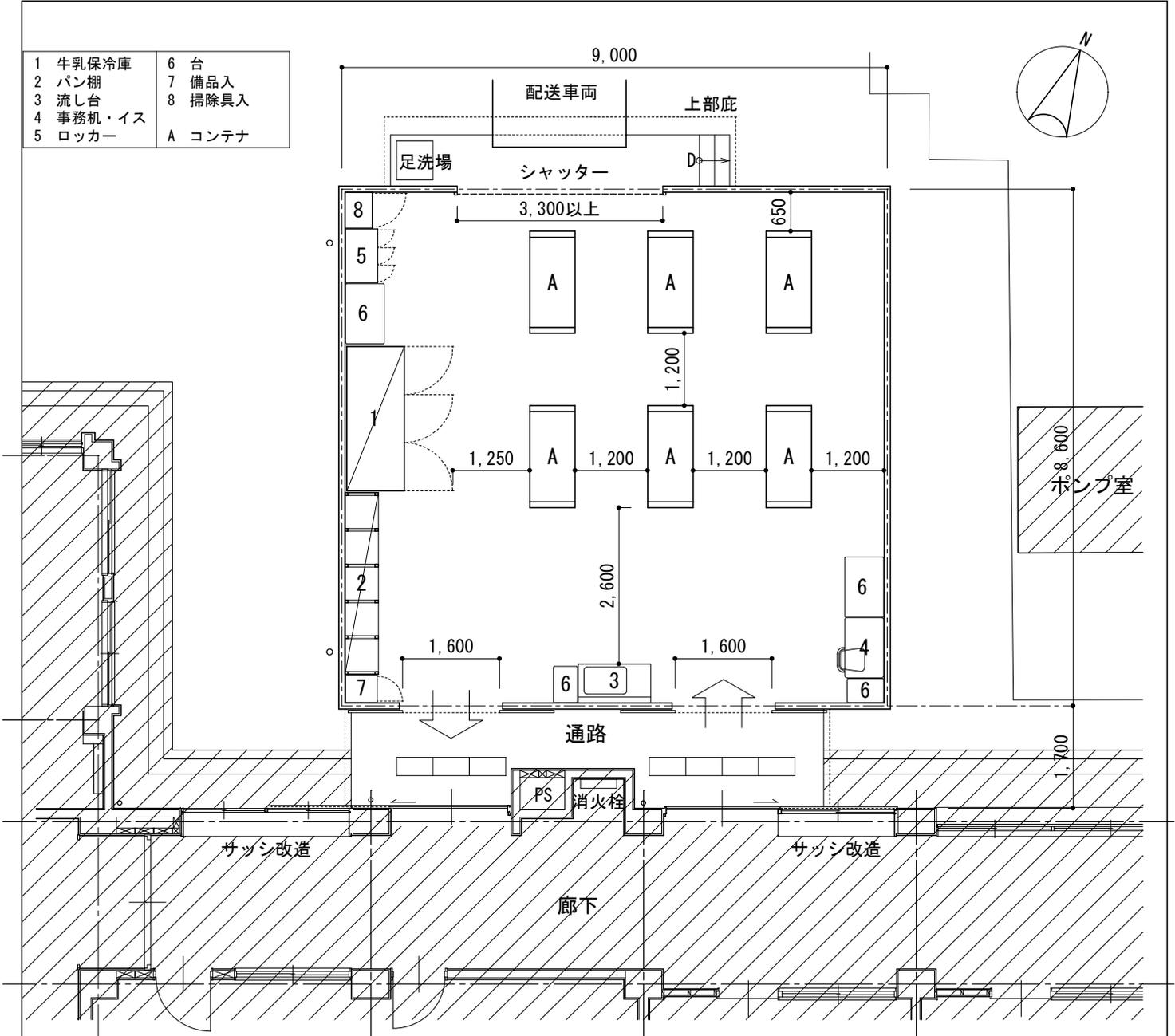
校舎廊下の出入口は外付け片引きサッシに改造
