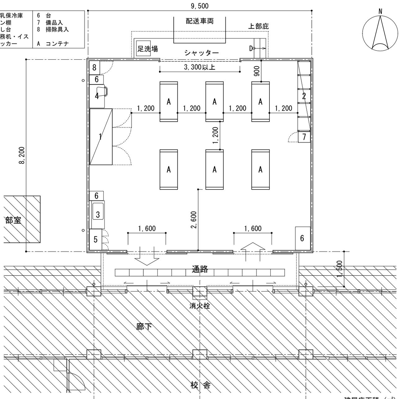
校舎廊下の出入口は外付け引き分サッシに改造
