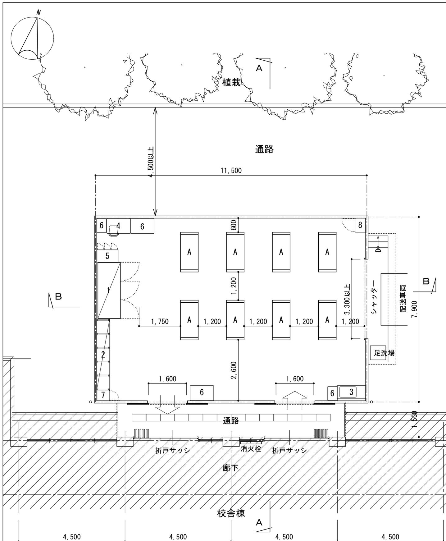
校舎廊下の出入口は折戸サッシに改造
