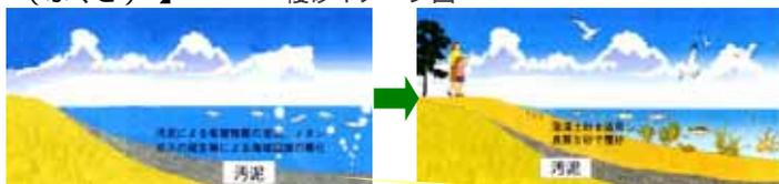
覆砂（ふくさ）は海底に堆積した底泥の上をきれいな砂で覆い、底泥からの栄養分の溶出を抑えたり、生物のすみやすい環境を創造する工法です。
