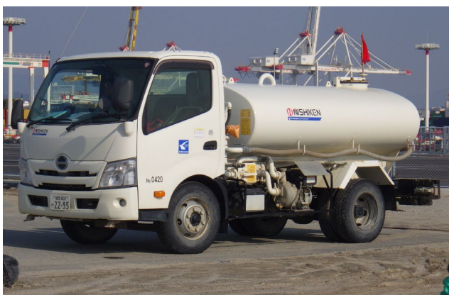
工事区域内の散水車両
