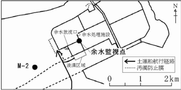
監視地点、土運船航行経路、汚濁防止膜設置箇所
