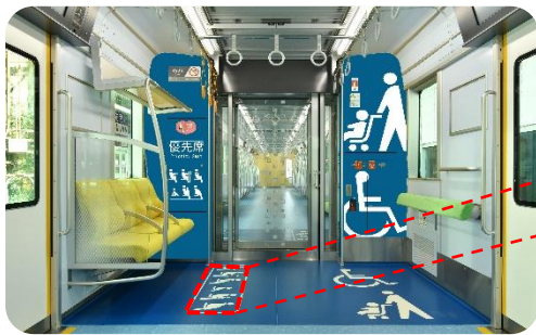
車内優先スペース改修後
