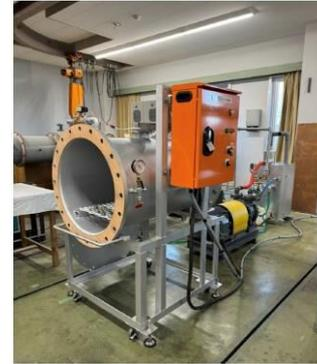
Fig. 1 減圧式マイクロ波照射型乾燥機
