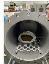
Fig. 3 竹チップを配置した炉内の写真
