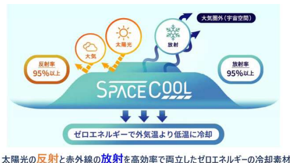
太陽光の反射と赤外線の放射を高効率で両立したゼロエネルギーの冷却素材
