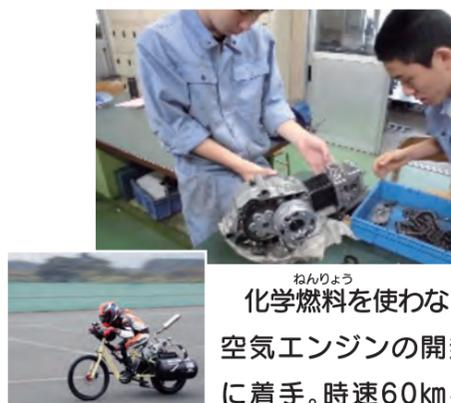
化学燃料を使わない空気エンジンの開発に着手。時速60kmを超えるエンジンの開発に成功し「世界最速の圧縮空気駆動自動車」としてギネス世界記録®に認定されました。
