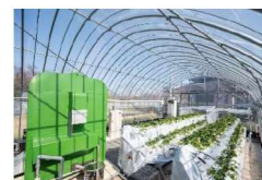
膜を用いて大気中の CO 2 を回収する技術を使った、施設園芸向けの CO 2 施用装置の実証実験を福岡市所有の農園で行っている九州大学発スタートアップ
