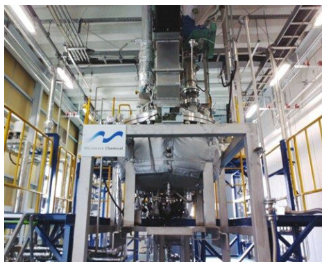
出典：マイクロ波技術を用いたケミカルリサイクル実証設備（NEDO、2022年）
