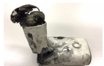
発火原因となった加熱式たばこ (リチウムイオン電池内蔵) 出典：(公財)日本容器包装リサイクル 協会HP
