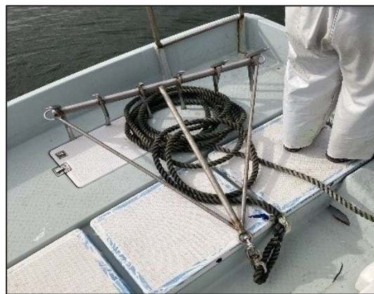
写真3 海底耕うんの様子(左)、海底耕うんに使用している器材(右)
