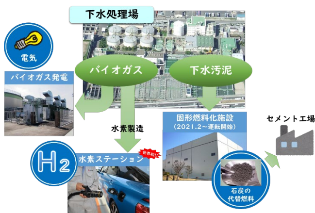
▲下水（生活排水）をエネルギー資源として有効利用
