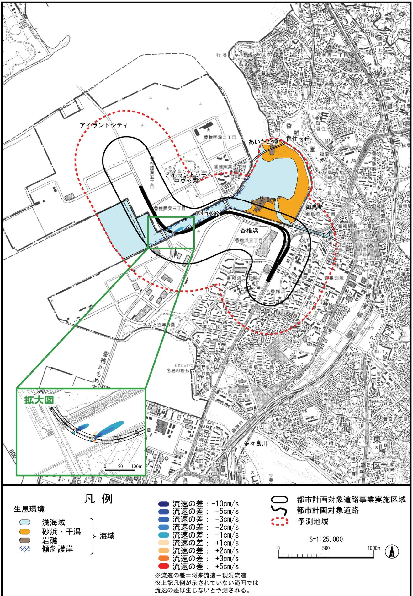
図 8-5-23 (2) 流況の変化に係る予測結果 (橋脚が 2 基の場合)
