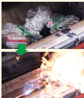
在垃圾回收车内卡式炉专用气罐着火(摘自:NITE)
