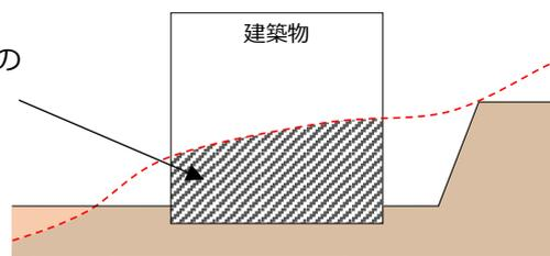
② 建築物の躯体から2m未満の範囲にある、採光・換気等のために必要となるドライエリアのための掘削等の行為
