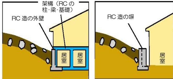
想定される土石流の高さや衝撃力に応じて定められた仕様を満たす鉄筋コンクリート造の外壁等を設ける
