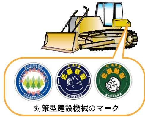
<低騒音型建設機械の採用>
