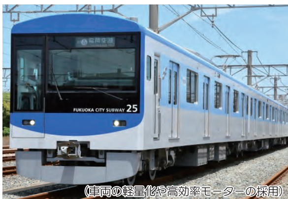
(車両の軽量化や高効率モーターの採用) 地下鉄車両の省エネルギー化(4000系)
