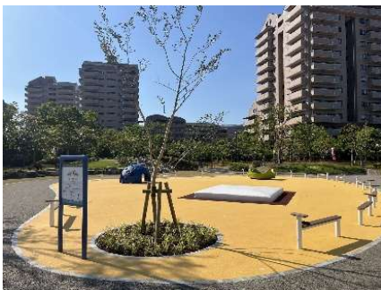
遊び場を緩やかに囲い 見守りにも使えるベンチ柵 安全性と走行性を兼ね備えた ゴムチップ舗装
